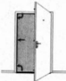
Auch durch Nebentüren (z.B. Keller) dringen Einbrecher in Häuser ein. Hier bietet das **Querriegelschloß** hohe Sicherheit. Es ist einfach zu montieren und zu bedienen. Ein oder zwei kräftige **Schubriegel** schaffen hier ebenfalls Sicherheit.
